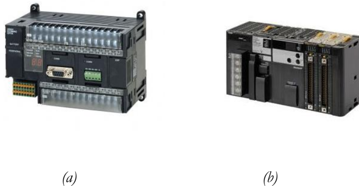
2.3. ábra. – A PLC felépítése. Kompakt és moduláris.
